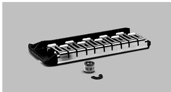
Магазин первичной защиты для кроссового оборудования HVt 71 (на 5 пар), оснащенный разрядниками и элементами термозащиты разрядников.
